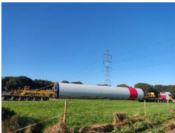
Manipulation des tronçons d'éoliennes
