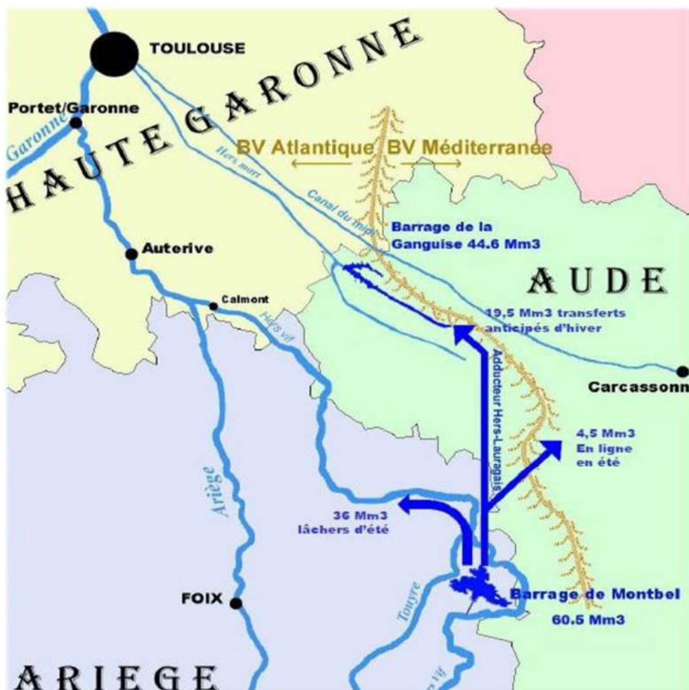
Figure 12 : Synoptique du fonctionnement du barrage de Montbel : Flux par branches et gestion multi-bassins
