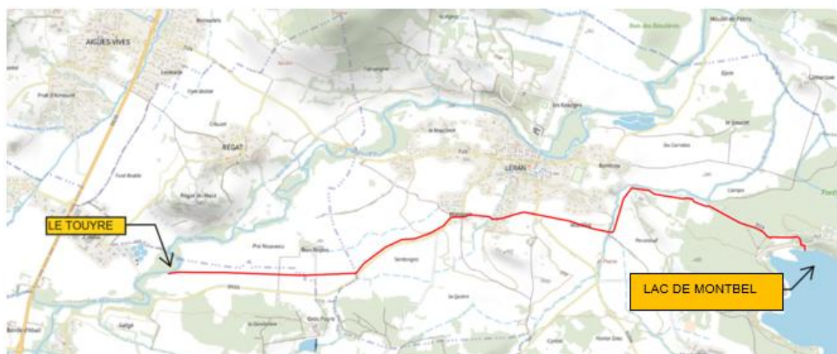
Figure 4 : Tracé de la conduite entre la prise d'eau dans le Touyre et le lac de Montbel
