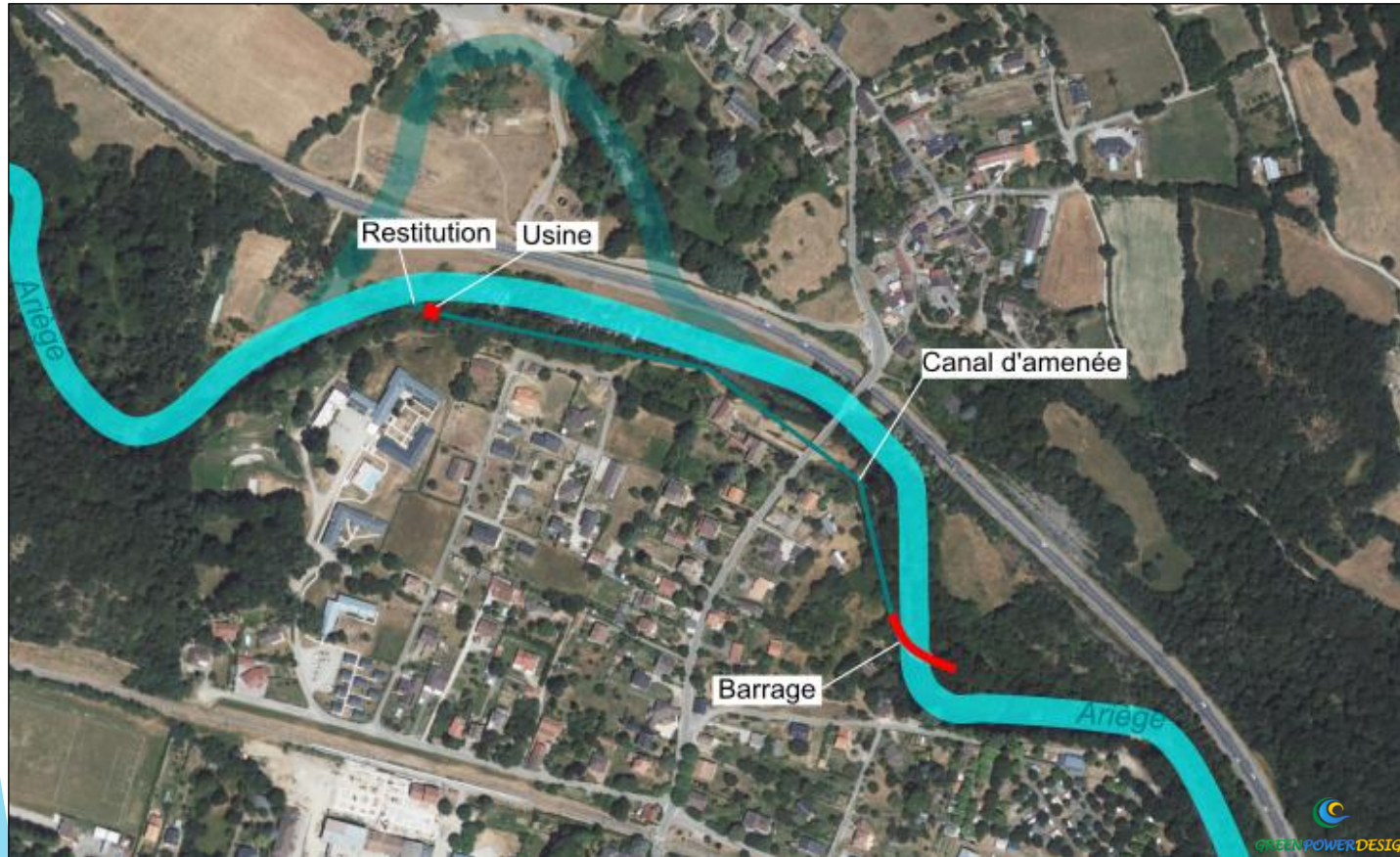
Localisation de l'aménagement hydroélectrique du Pont de Verdun dans sa configuration projetée
