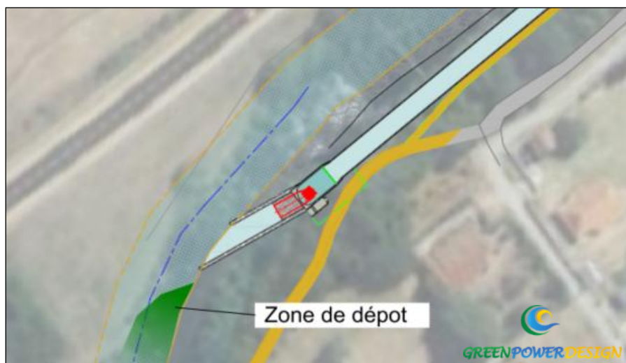
Figure 32 : Localisation de la zone de régalage des matériaux issus du batardeau amont en rive gauche
