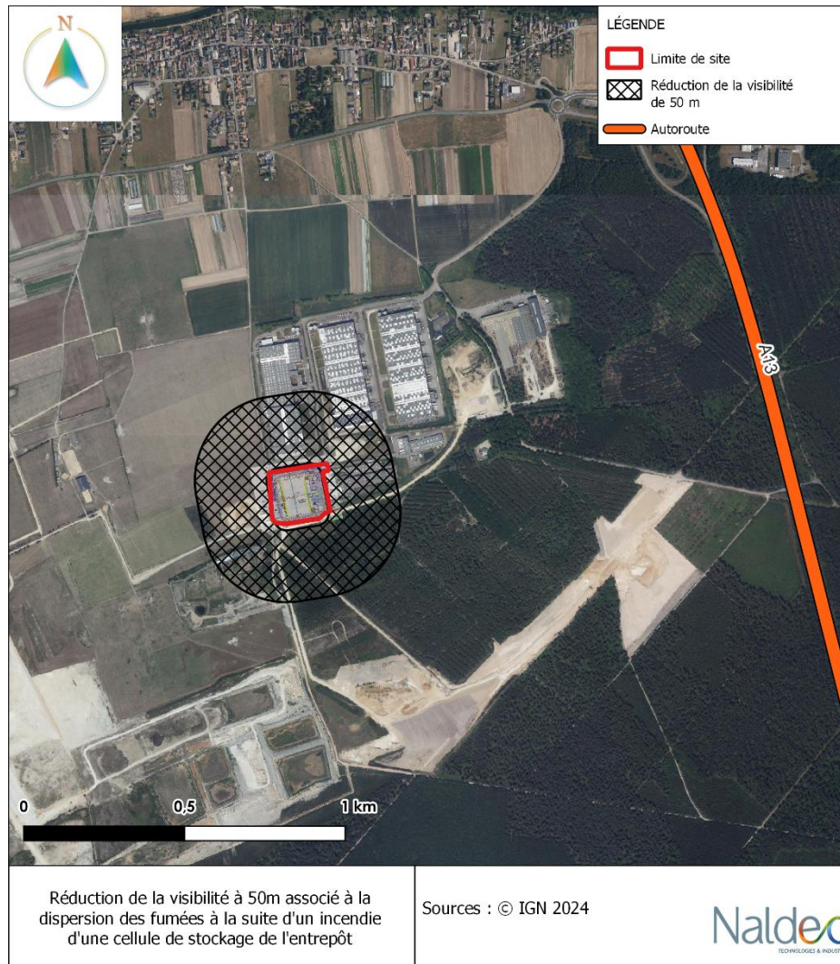
Figure 26 : PhD 2.2_Réduction-Visibilité_Fumées : Réduction de la visibilité de 50 m en cas de dispersion des fumées lors d'un incendie d'une cellule de stockage
