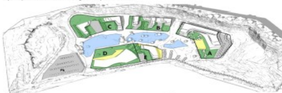
Vue de la partie du bassin versant (bleu) dévié vers le canal de Pierrelatte
