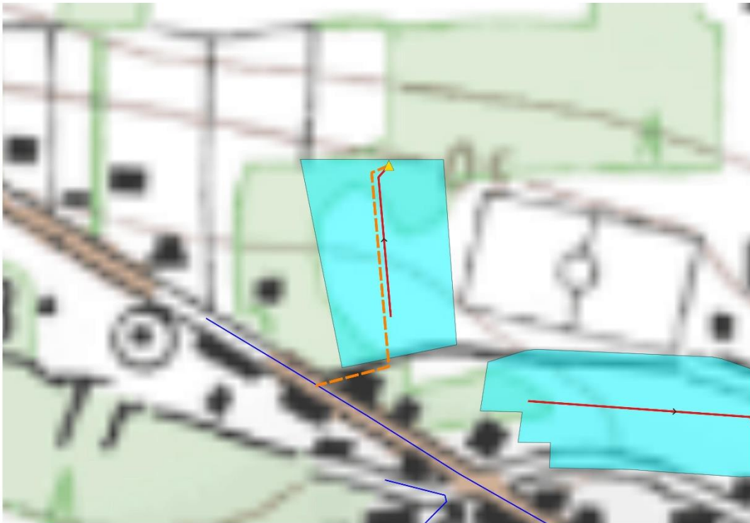
Figure 19 : Projet de raccordement au réseau de la STEP de la Chapelle-de-Brain
