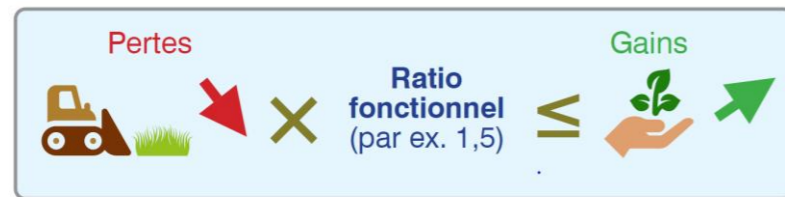
Figure 16. Intervention du ratio fonctionnel pour évaluer l'équivalence fonctionnelle. Il y a équivalence fonctionnelle, si la perte multipliée par le ratio fonctionnel est inférieure ou égale au gain.
