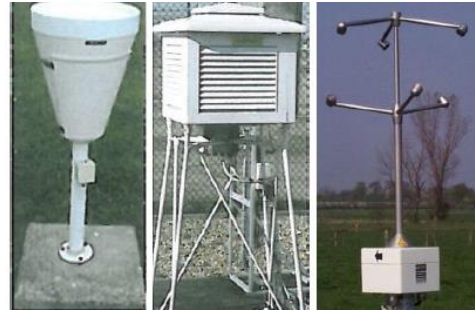
Exemples d'équipements pour les mesures de pluviométrie, température et vent ©EDF
