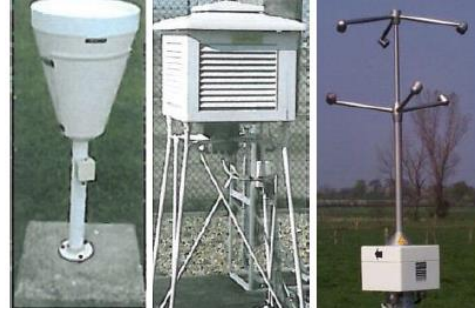
Exemples d'équipements pour les mesures de pluviométrie, température et vent ©EDF
