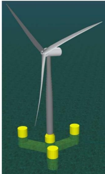
Figure 1-5 : Représentation tridimensionnelle de l'éolienne et de la fondation flottante
