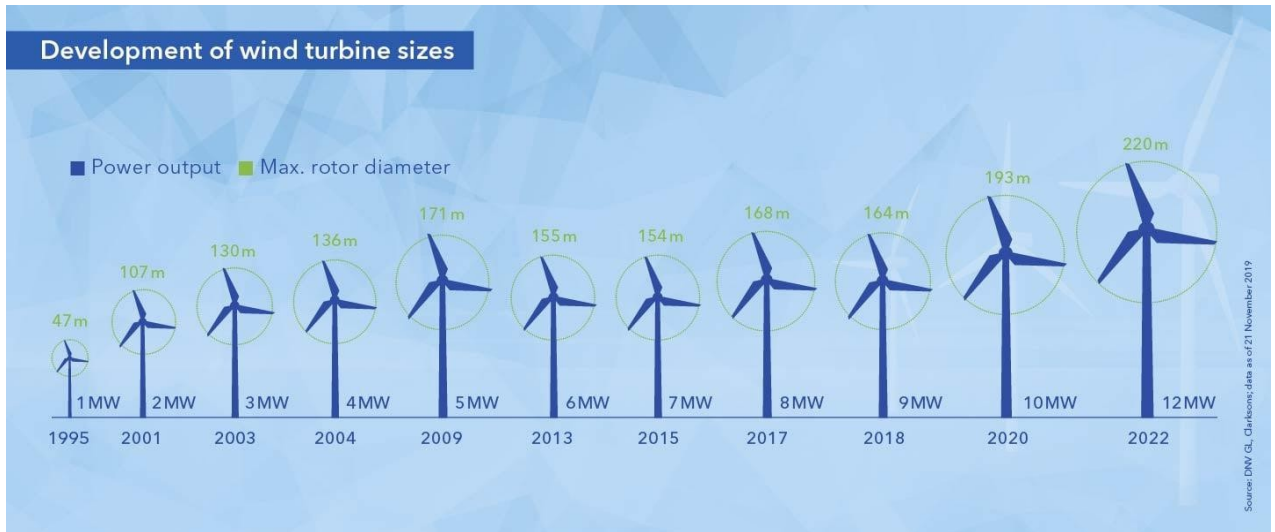
Figure 1-2 : Évolution des éoliennes offshore, avec indication de la puissance nominale unitaire de l'éolienne [MW], du diamètre du rotor [m] et de l'année de mise en service du parc éolien [Source : DNV GL, Clarksons 2021].
