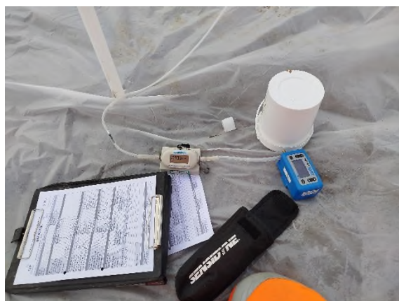
Vérification du débit lors du prélèvement de PzR1
