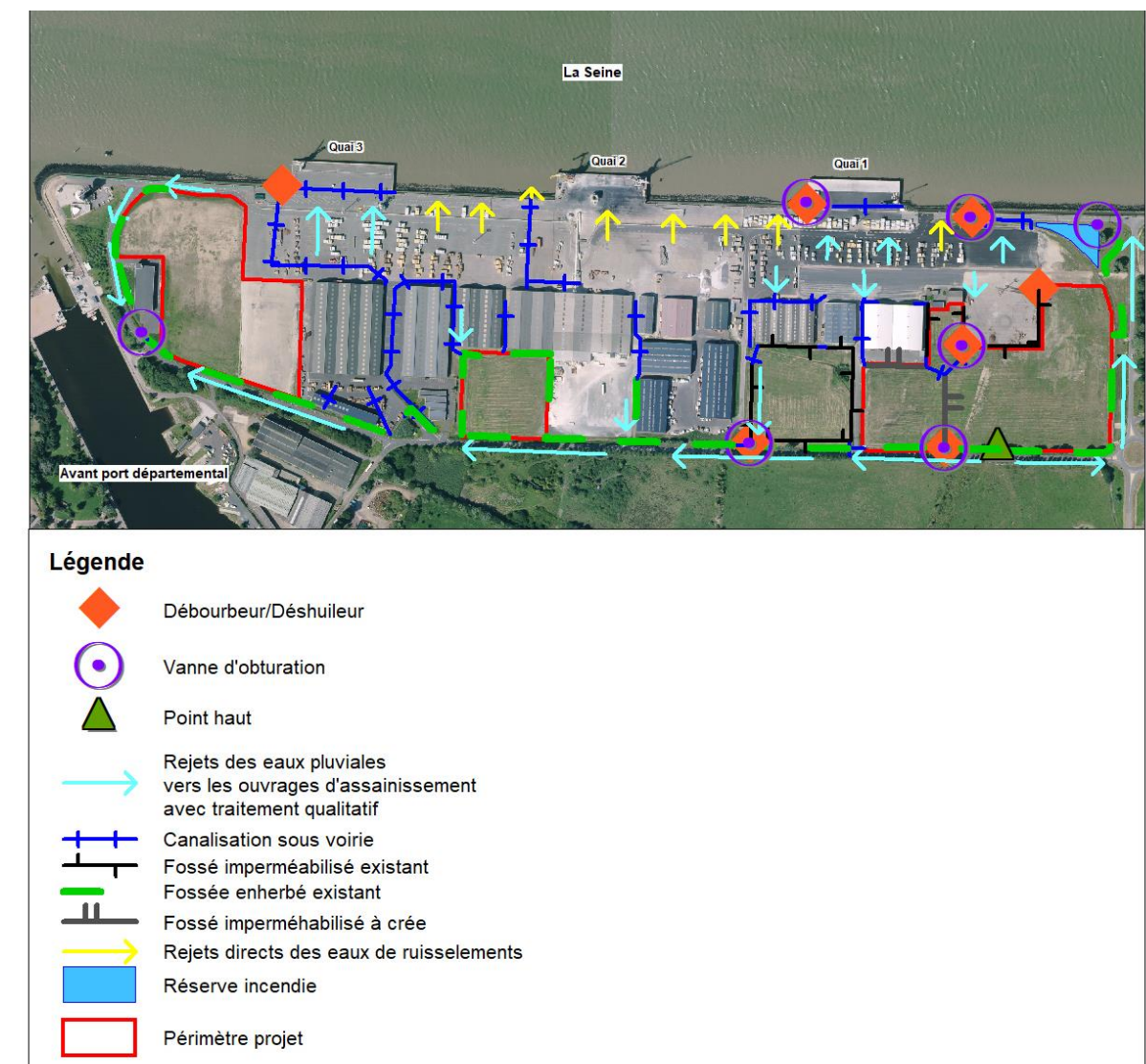
Schéma 6 : Fonctionnement hydraulique en situation actuelle
