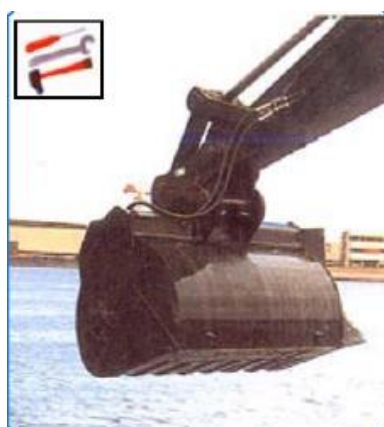
Figure 24 : Illustration d'un godet obturable
