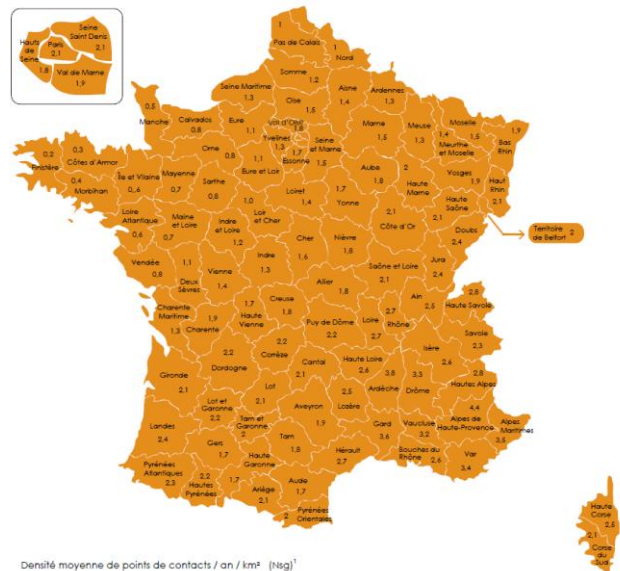
Figure 57. Carte de la densité de foudroiement de la France – Norme NFC 17-102 (05-2015)
