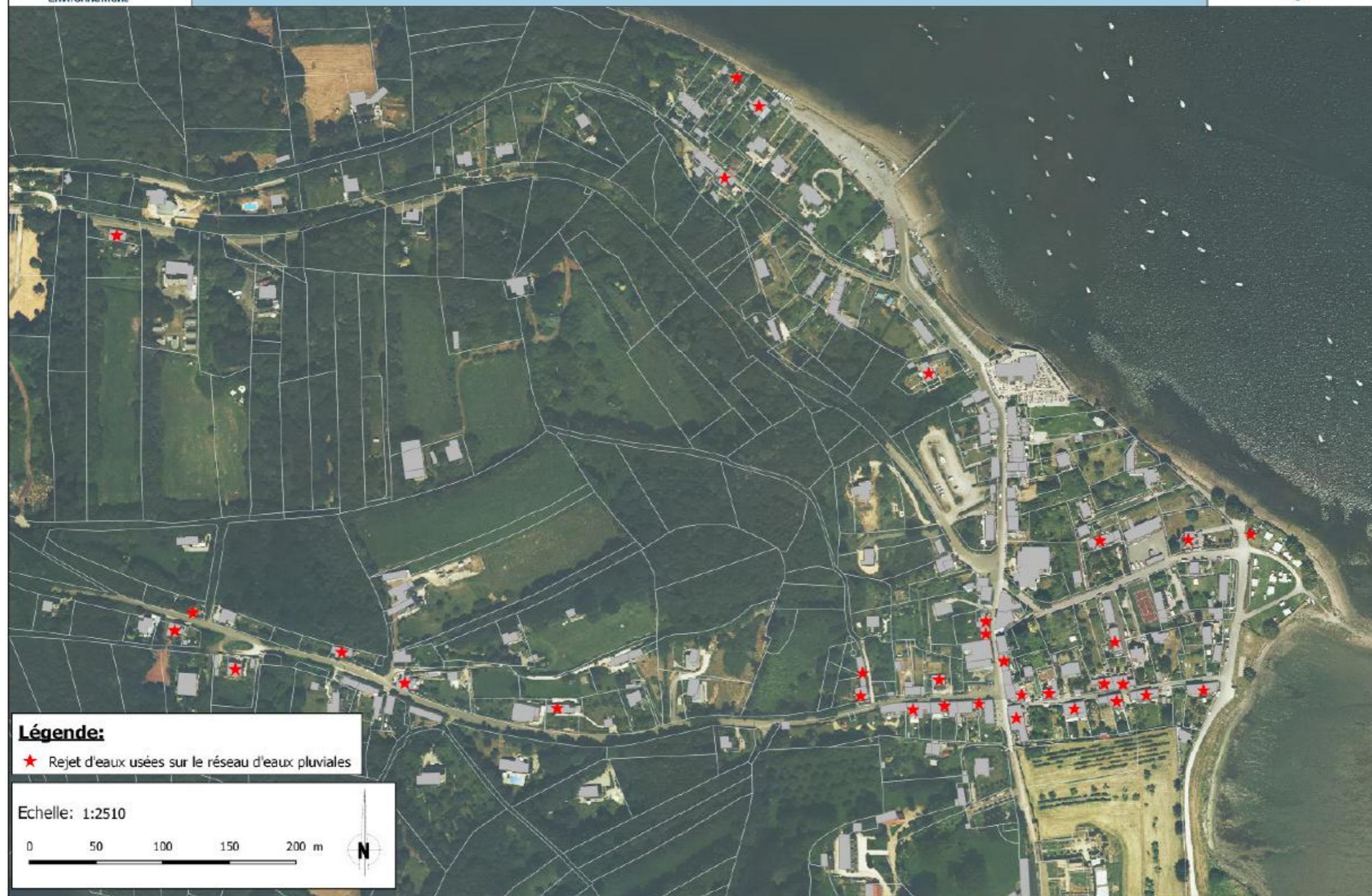
Figure 30 : Carte des rejets directs d'eaux usées vers le réseau d'eaux pluviales
