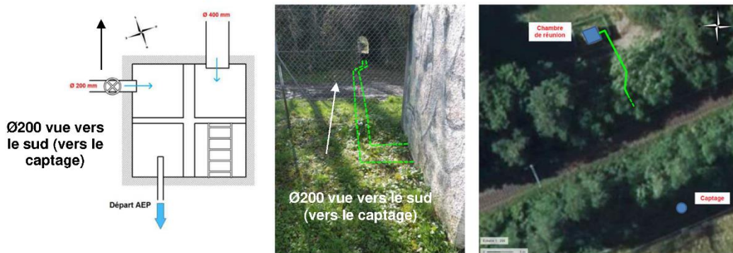
Figure 17 : Implantation de principe de la canalisation en 200mm de chambre de réunion du Bois d'Anthy (source : rapport d'inspection de CPGF-Horizon du 12/03/2020)
