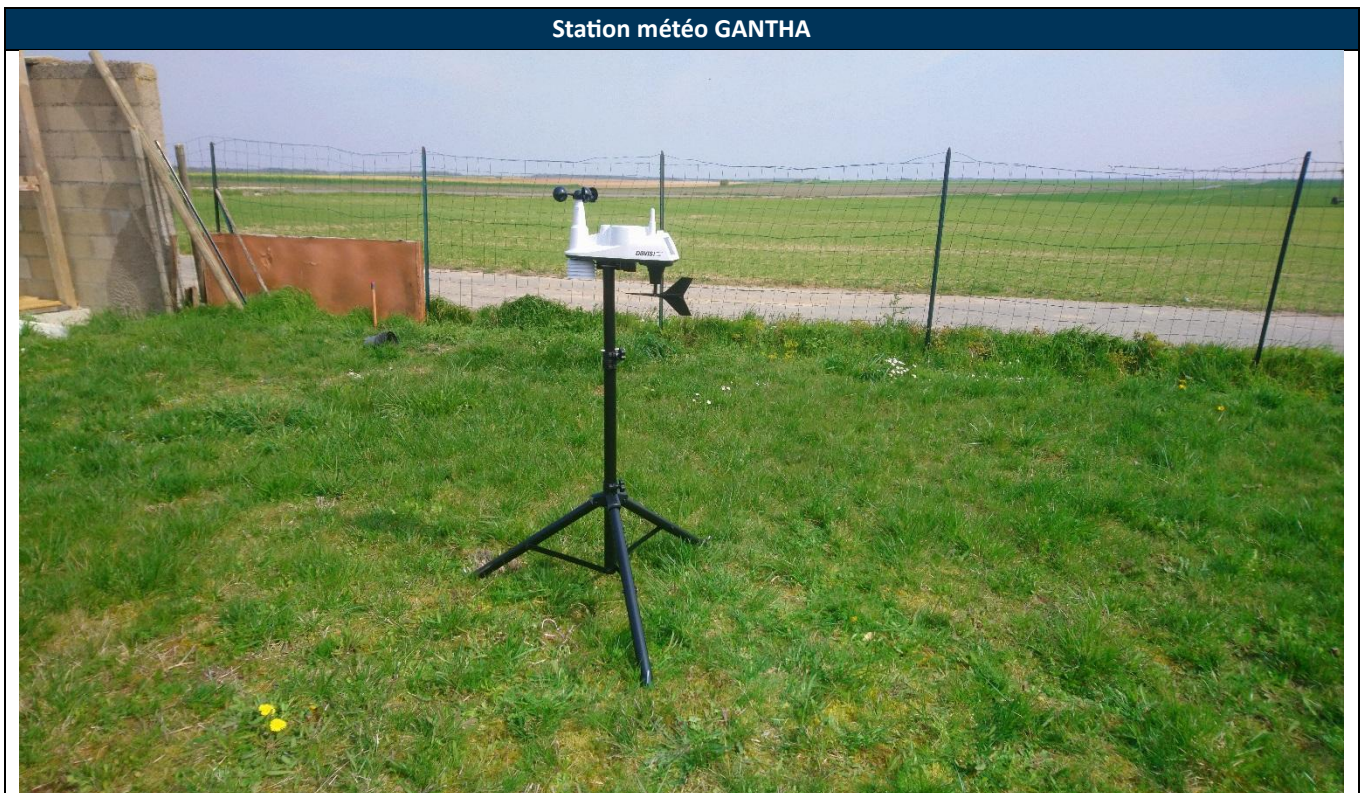
Figure 2 : Station météorologique à 1,5 m
