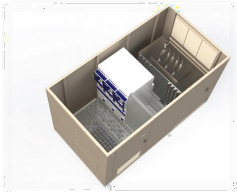
Figure 11 : Schéma d'un poste de transformation (Source : Qair)
