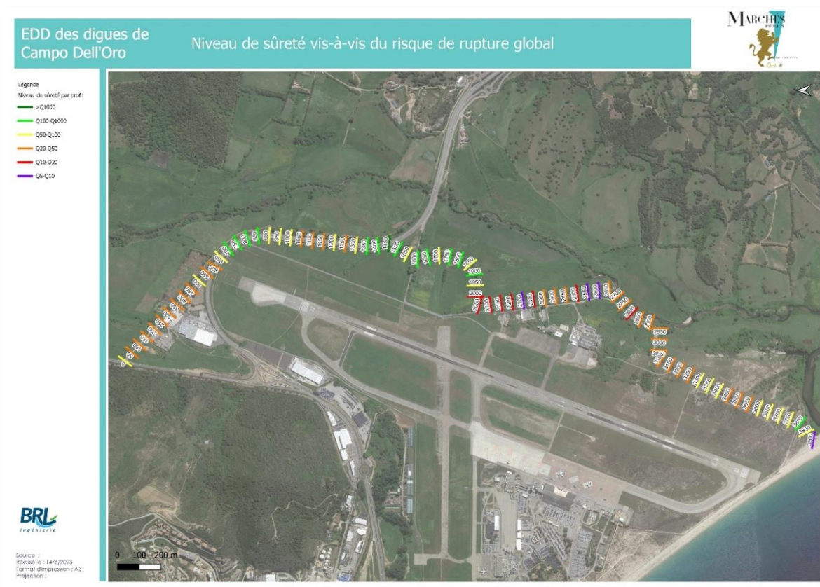
Figure 20 : Niveau de sûreté du système d'endiguement de Campo Dell'Oro (Source CAPA/BRLi)
