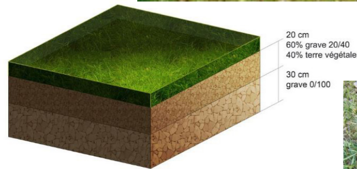
La proportion de terre végétale et de grave est à ajuster en fonction de la portance du sous-sol.
