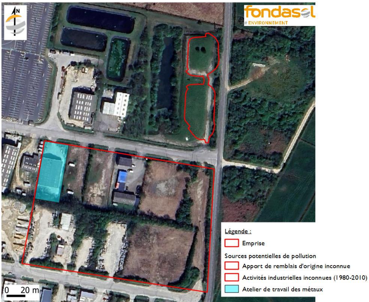
Figure 13 : Plan de synthèse des sources potentielles de pollution recensées sur site lors de la visite de site et de l'étude historique
