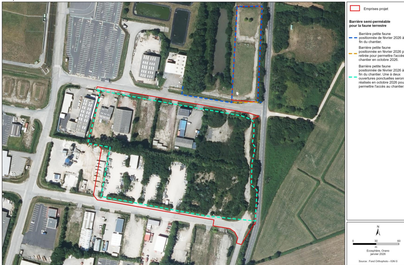
Carte 19. MR4 – mise en place d'une barrière semi-perméable pour la faune terrestre
