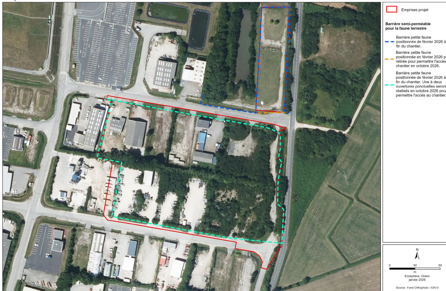
Figure 83 : MR4 – mise en place d'une barrière semi-perméable pour la faune terrestre
