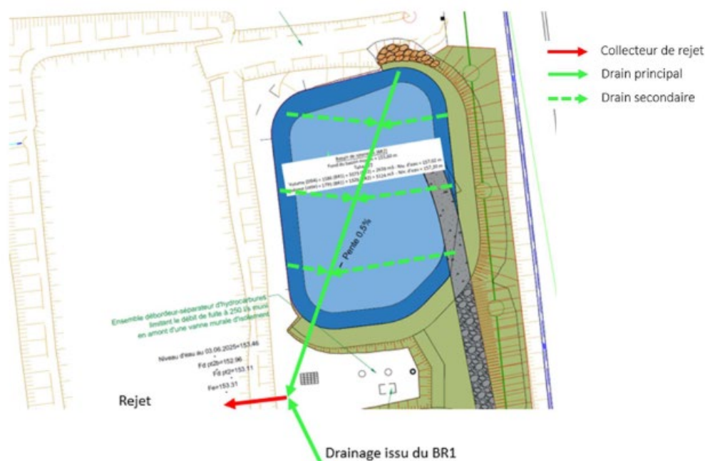
Figure 78 : Schéma de principe du drainage sous le bassin BR2
