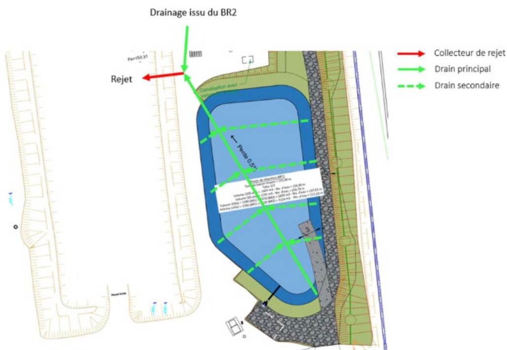
Figure 77 : Schéma de principe du drainage sous le bassin BR1
