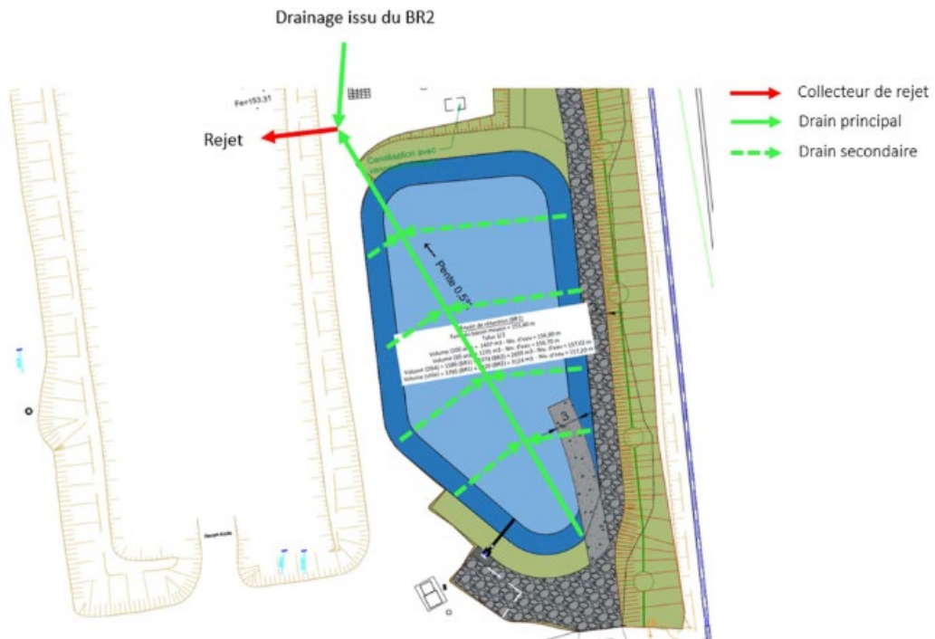
Figure 15 : Schéma de principe du drainage sous le bassin BR1
