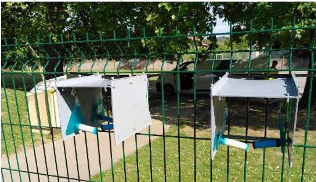
Photographie des tubes Radiello et les abris de protection utilisés
