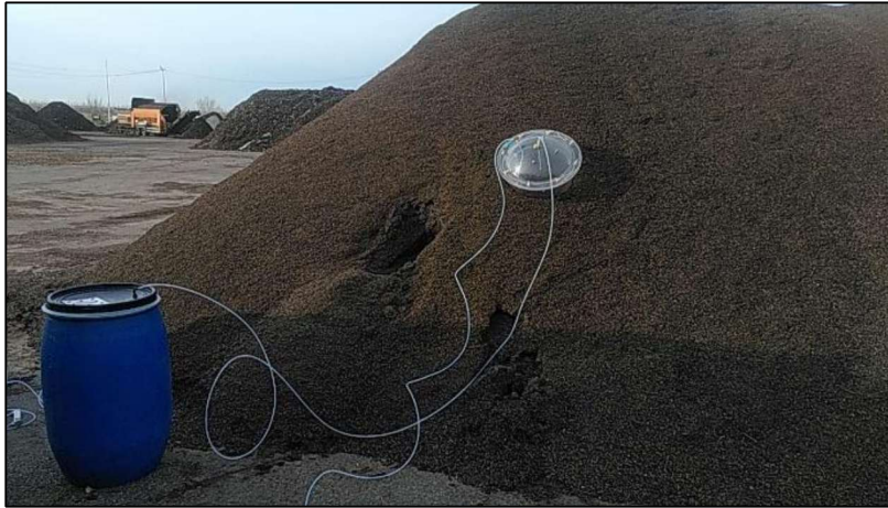
Figure 4 : Exemple d'un prélèvement surfacique réalisé sur un andain de produits finis de boues P4
