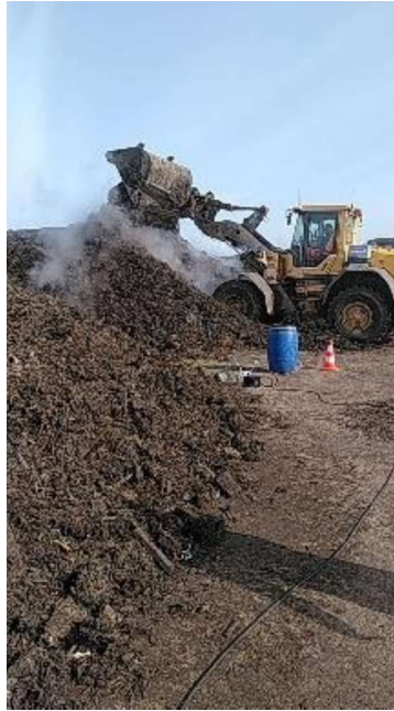
Figure 13 : Retournement d'andain de fermentation des boues lors de la campagne de prélèvement (21/02/2024)
