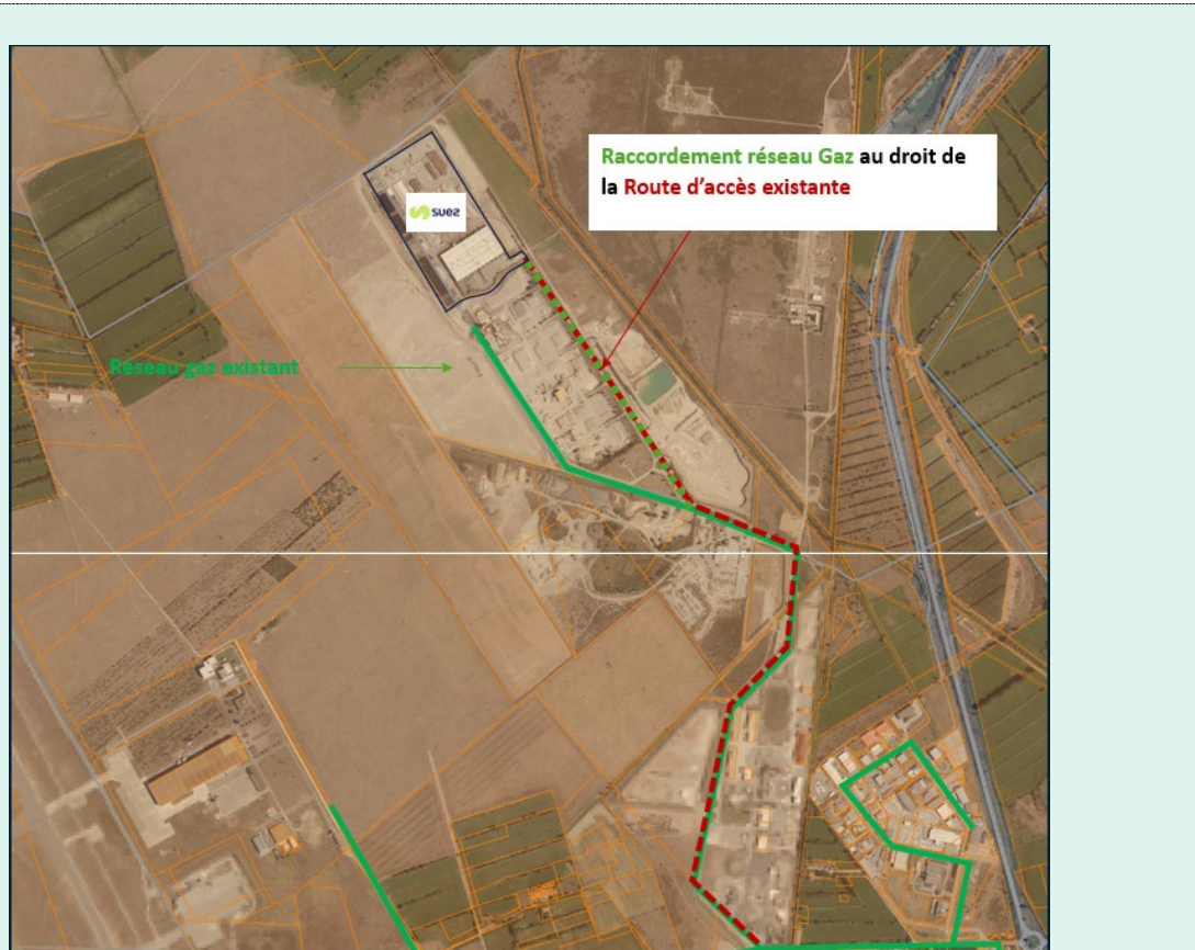
Canalisation gaz enterrée au droit de la route existante
