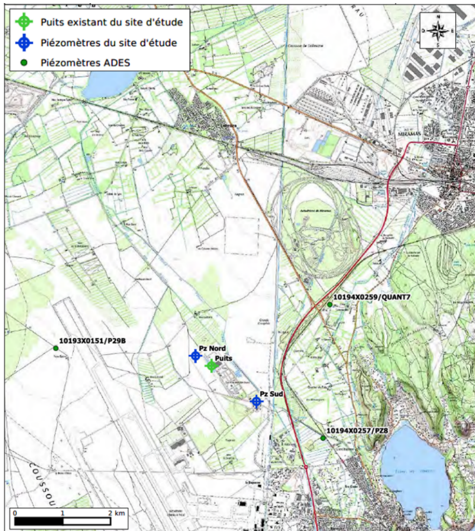
Fig 2-3 Plan d'implantation des piézomètres au droit et dans l'environnement du site SUEZ RV (Source : BERGA Sud, Rapport n°13/074 A 17 044 du 3 septembre 2018)
