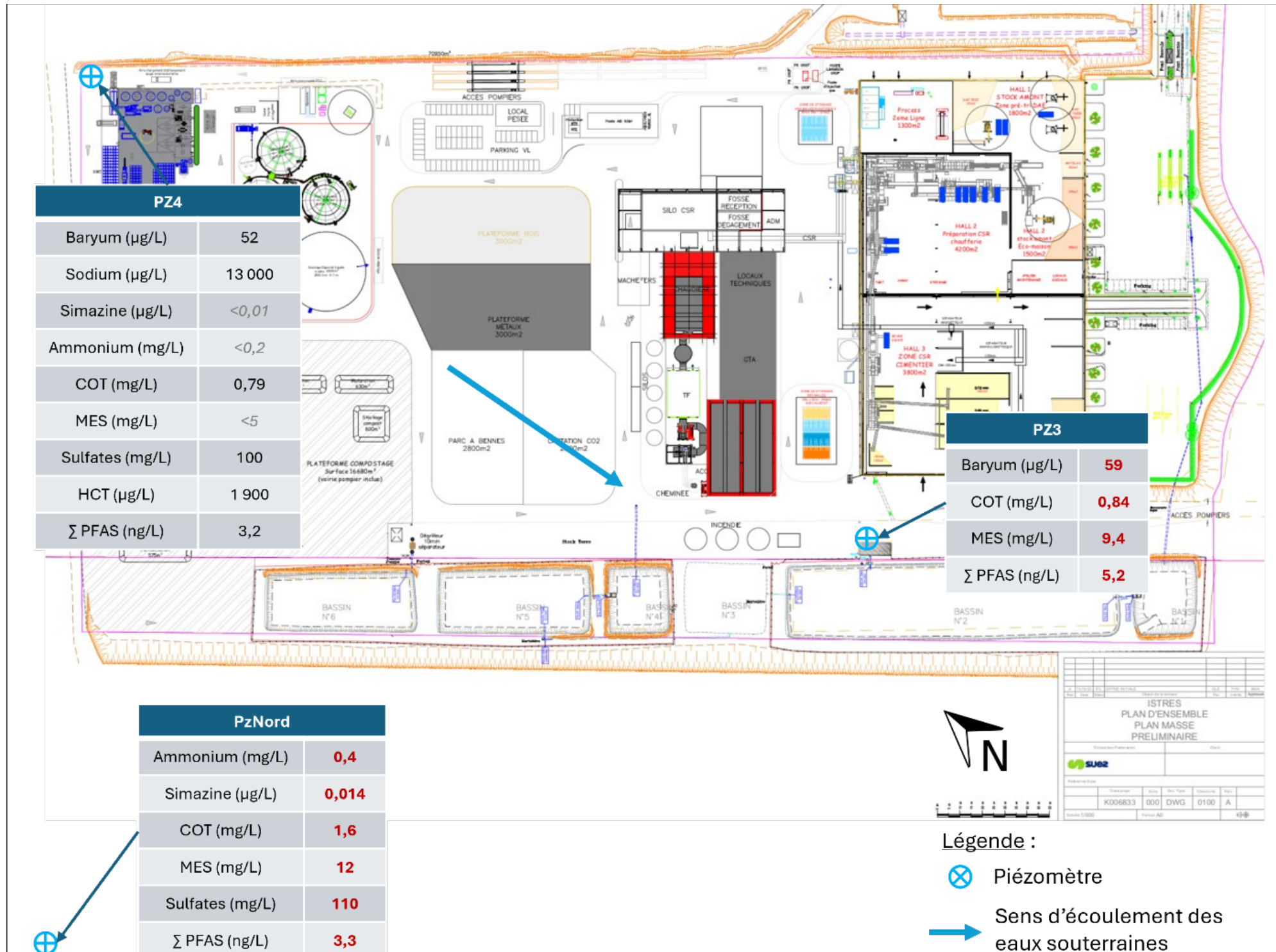
Fig 5-2 Cartographie des principaux résultats sur les eaux souterraines sur plan de masse du projet
