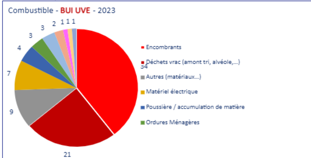
Figure 36 : Types de combustibles impliqués dans les incendies des installations d'incinération de déchets en 2023 (REX interne SUEZ)
