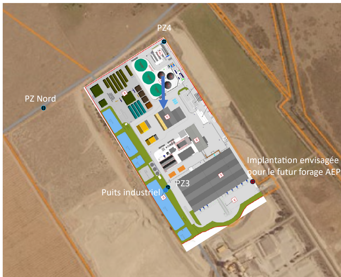
Figure 45 : Localisation des piézomètres installés dans le cadre du projet (source : SUEZ)
