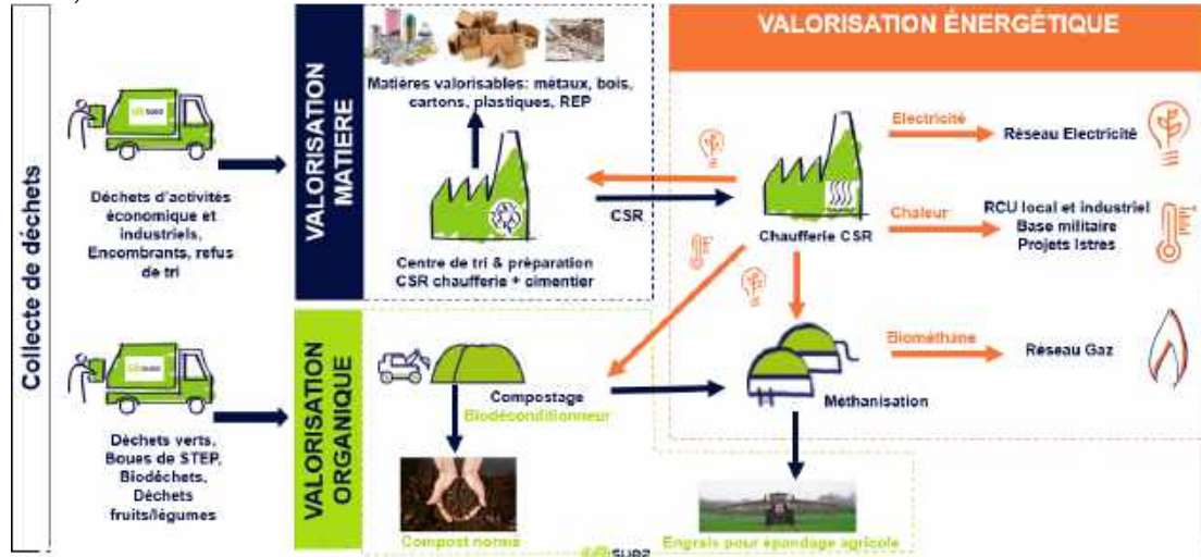
Figure 140 : Synthèse des futures contributions du site sur les volets recyclage et production énergétique (source : SUEZ)
