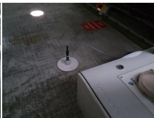
Figure 2 : Exemple de positionnement du microphone au sein d'une éolienne
