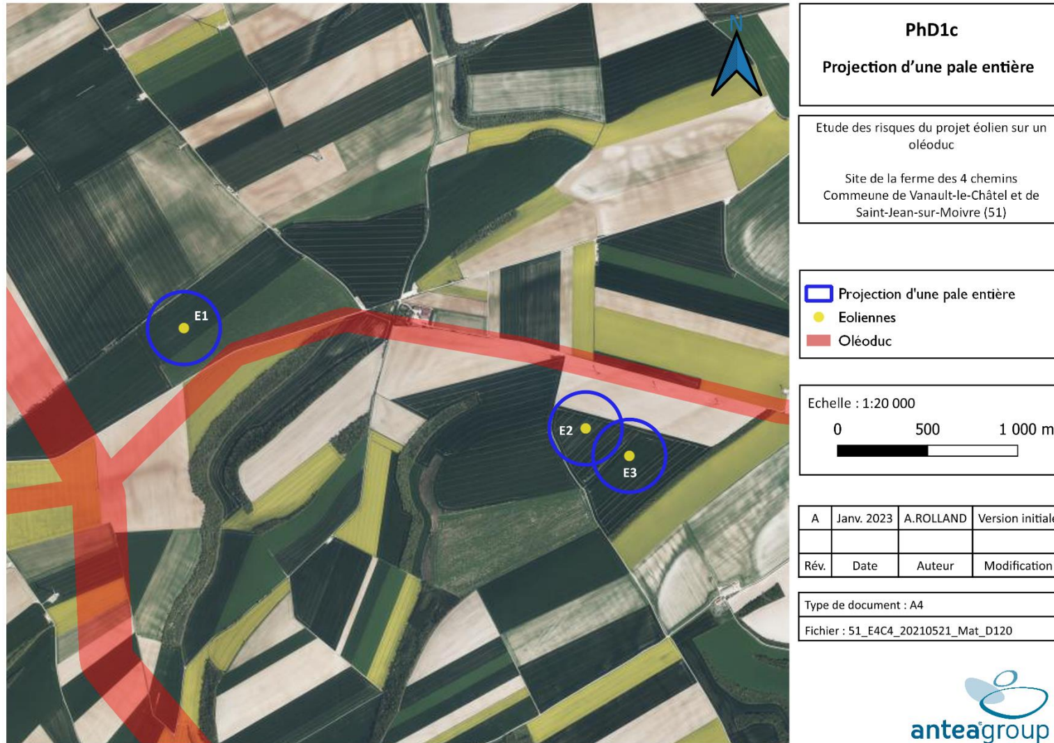
Figure 6 : Distances d'effets de projection d'une pale entière
