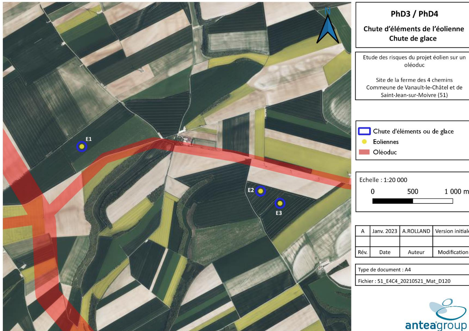
Figure 8 : Distances d'effets de chute d'éléments de l'éolienne ou de chute de glace
