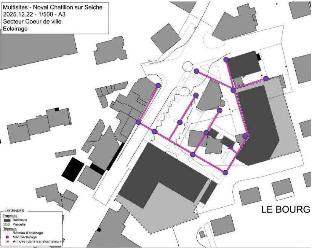
Modalités de raccordement du secteur « Cœur de Ville » au réseau d'éclairage public - ABEIL
