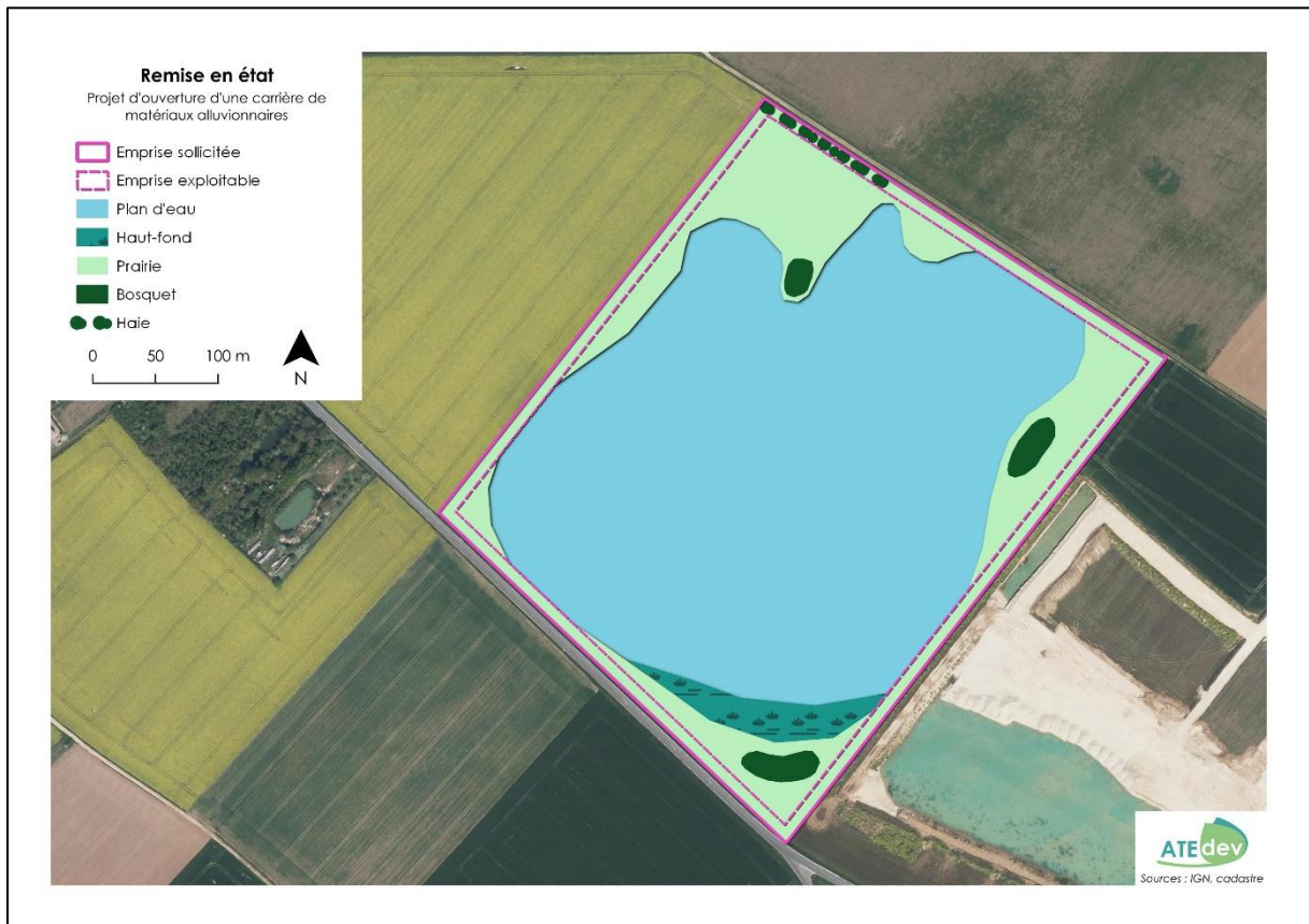
Carte 9 : Localisation des différents éléments de la remise en état du site (Source : ATE Dev)
