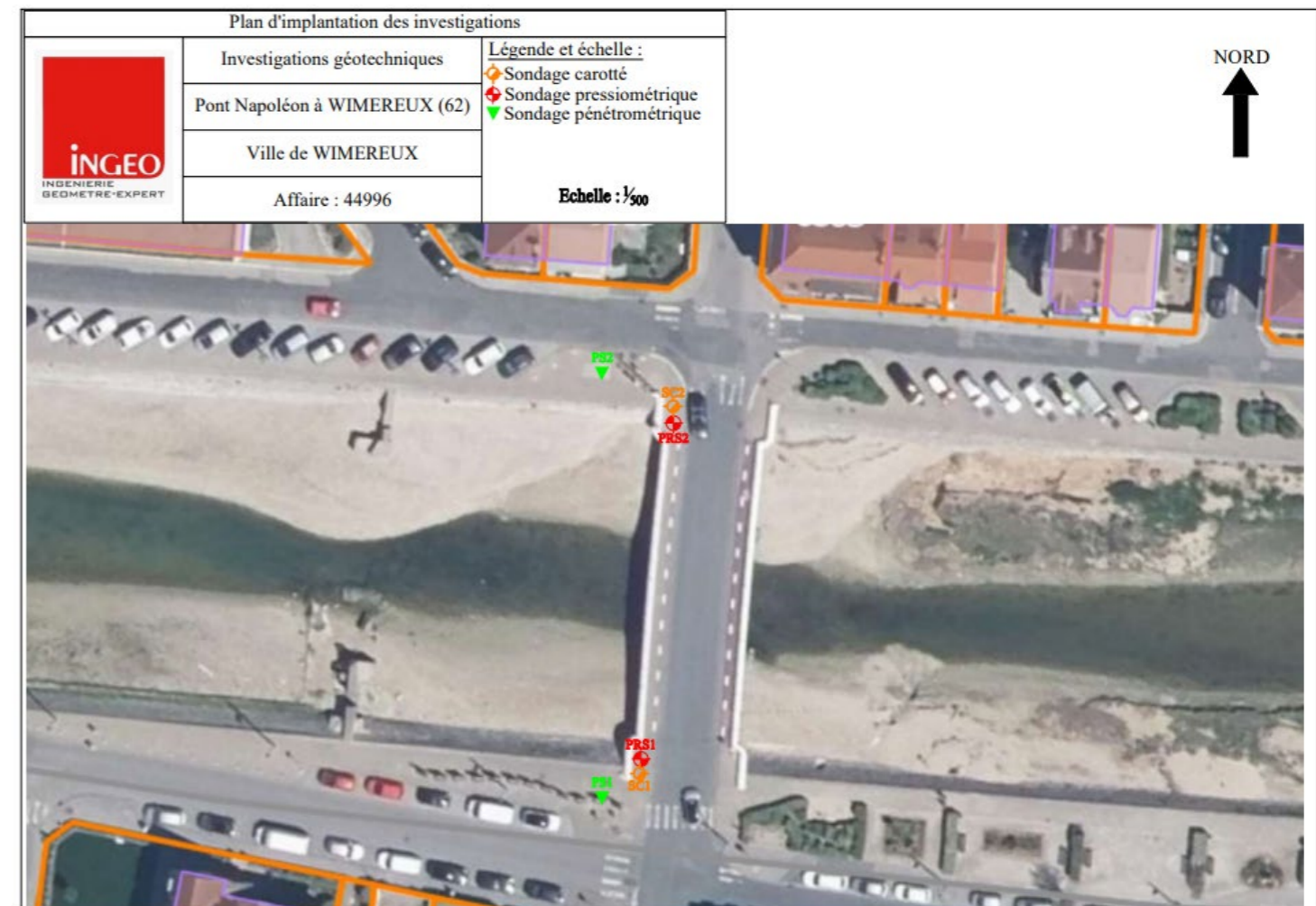
Figure 28 : localisation des sondages effectués. Source : GINGER CEBTP.
