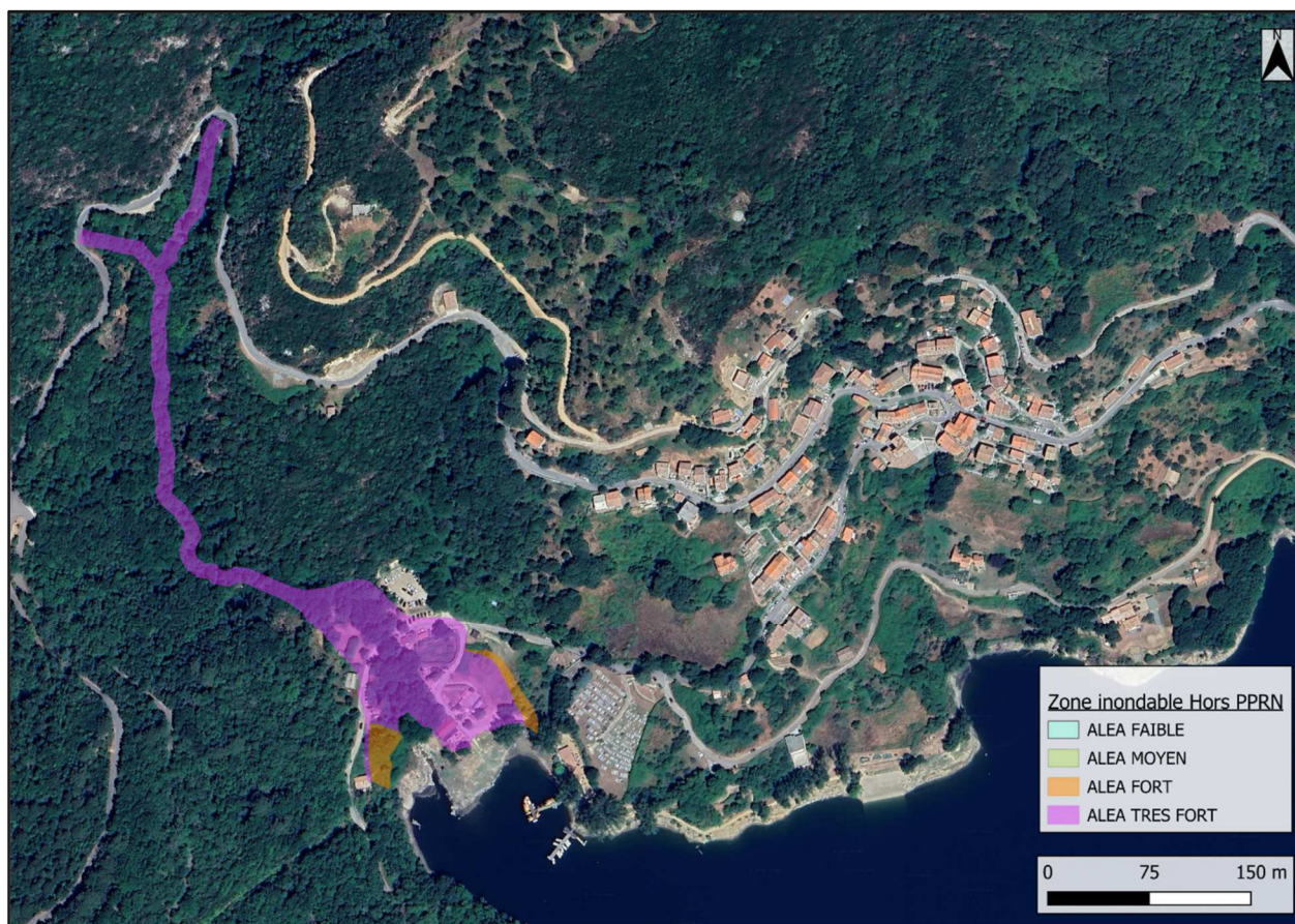
Figure 13 : Zone inondable par débordement (Etude SOGREAH-2007)
