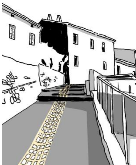
Béton gris et canivea central en pierre
