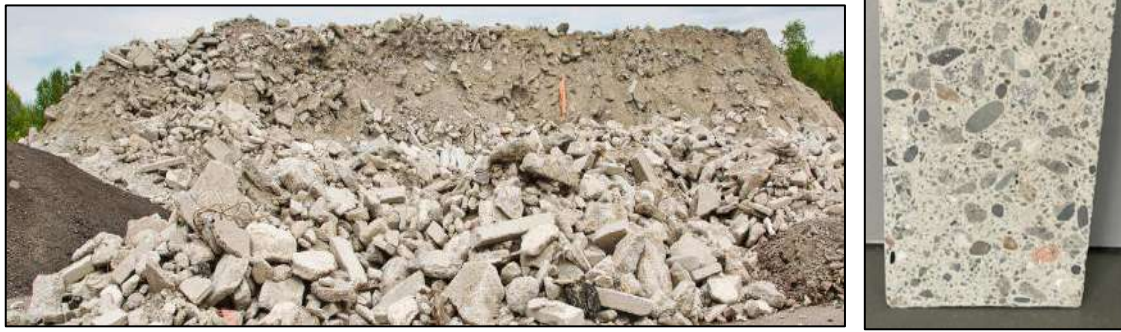
Figure 7 : valorisation de déchets bétons
