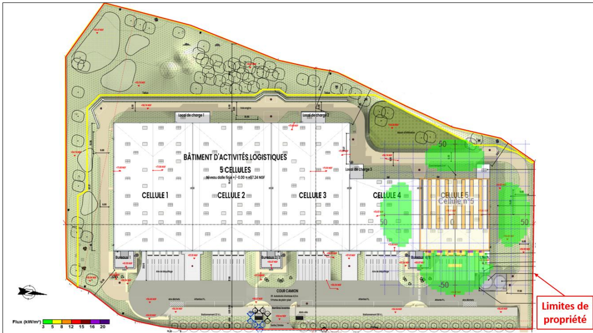
Figure 114 : Cartographie des flux thermiques rayonnés en cas d'incendie de la cellule 5 (LC/SLC)
