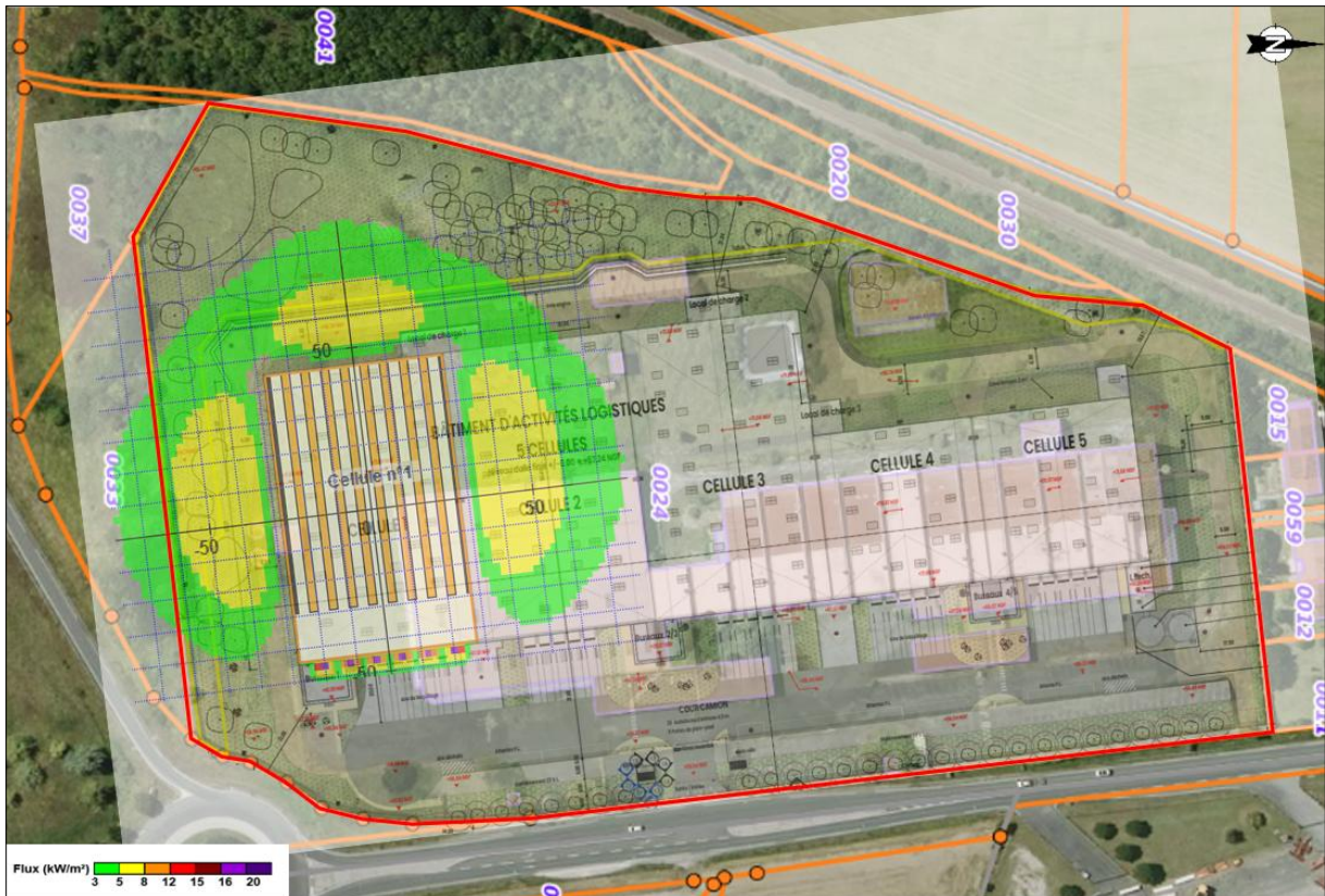
Figure 120 : Cartographie de l'AM1 – Incendie de la cellule 1
