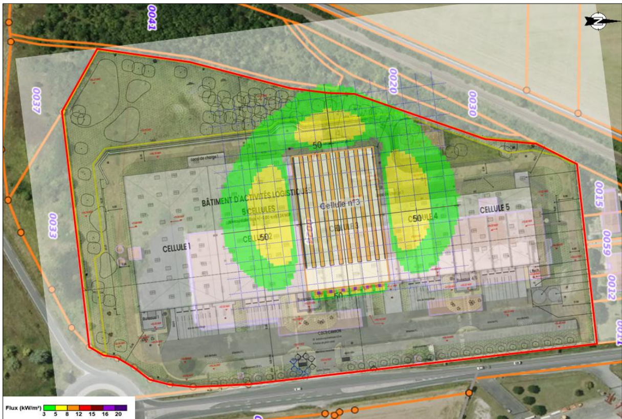
Figure 122 : Cartographie de l'AM2 – Incendie de la cellule 3
