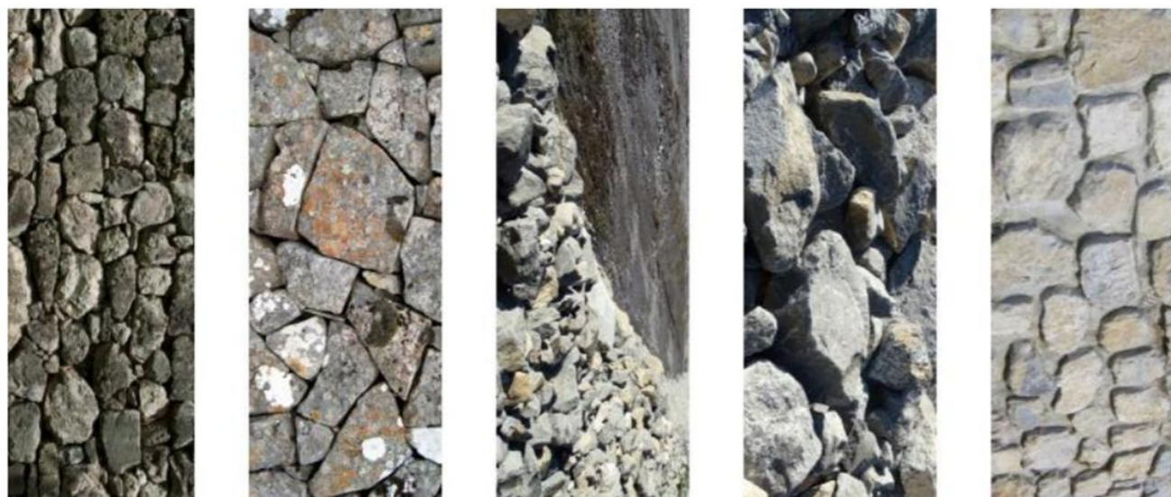
Figure 18 : Pierres des enrochements
