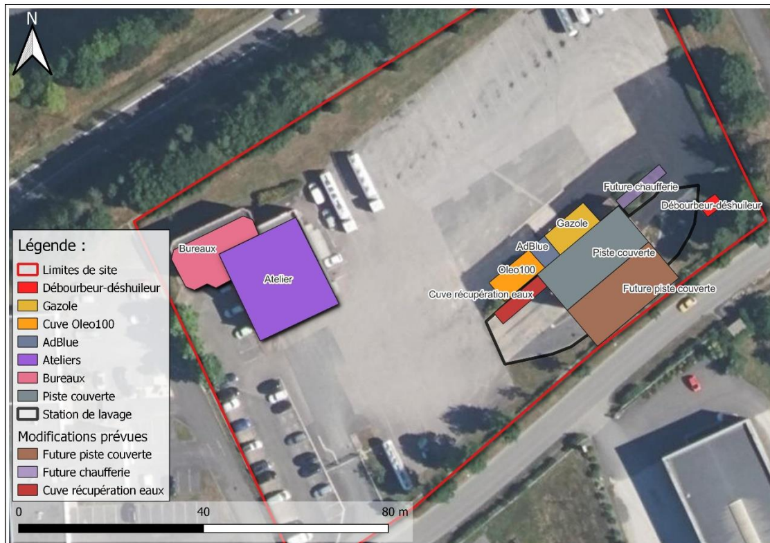
Figure 9 : Localisation des installations de distribution de carburant
