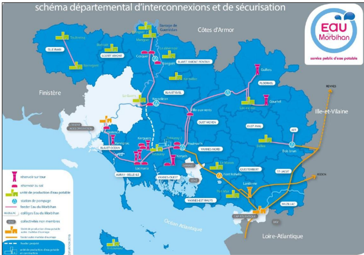
Figure 52 : Schéma des interconnexions du réseau AEP
