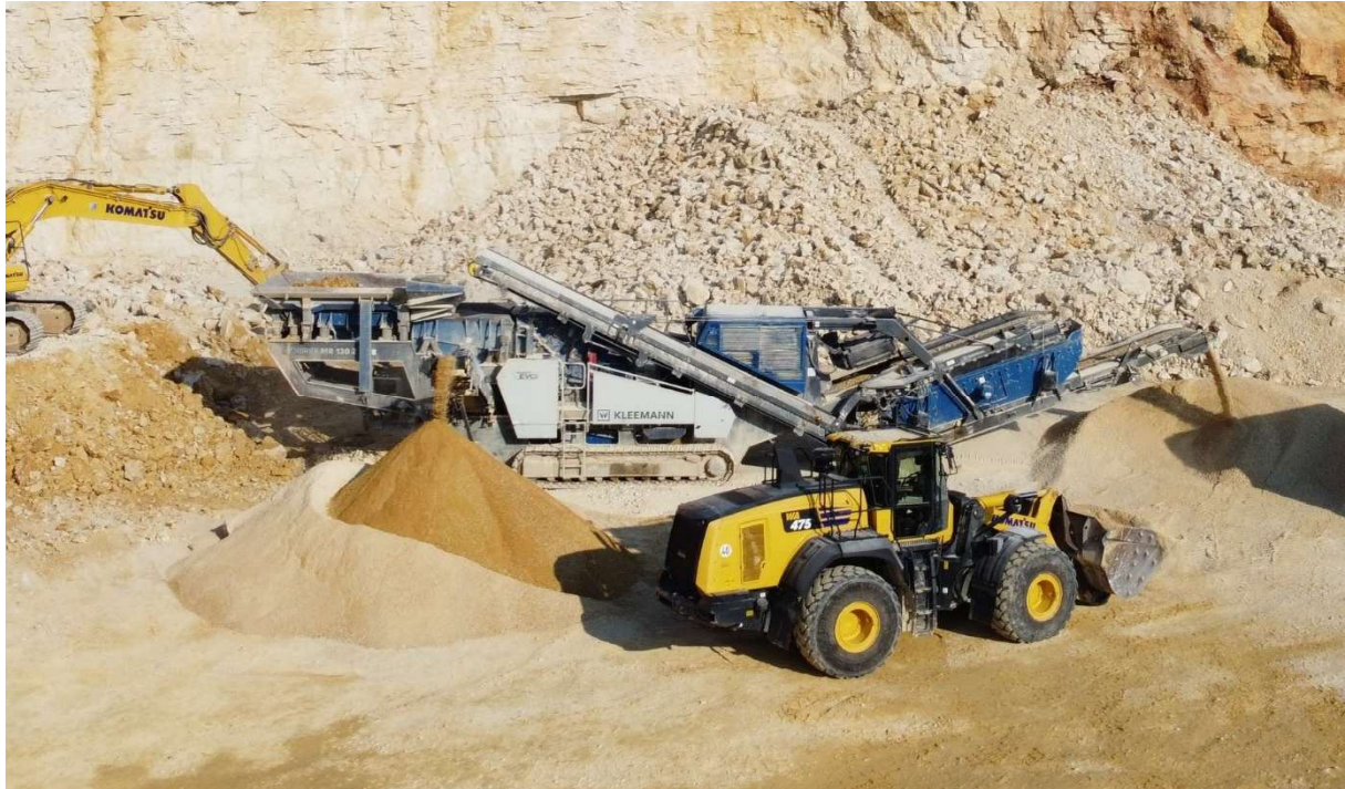
Figure 7 : Groupes mobiles de traitement des matériaux
