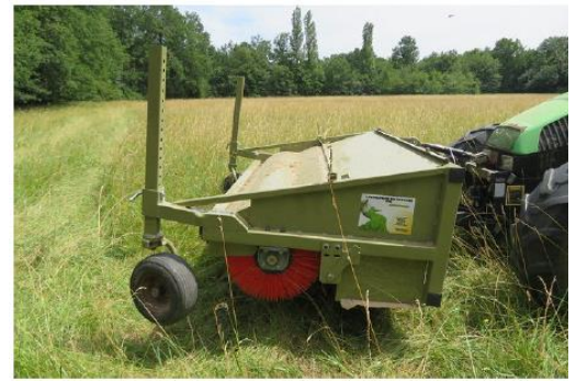
Figure 10 - Brosseuse à graines tractée
