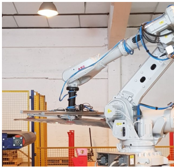
Figure 6 - Chargement du modules laminés avant découpage, broyage et séparation des éléments (Source : REDEN)
