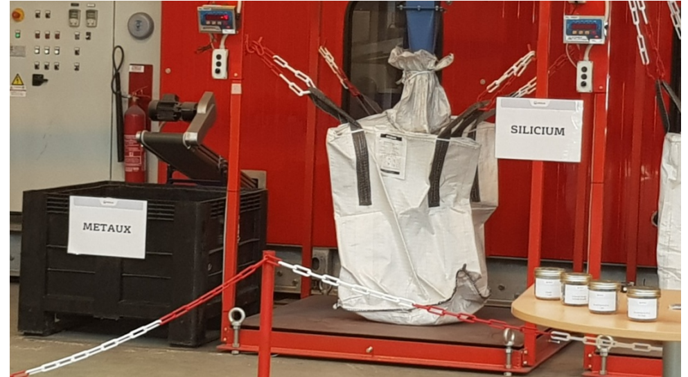
Figure 20 - Séparation et triage des composants (Source : REDEN)
