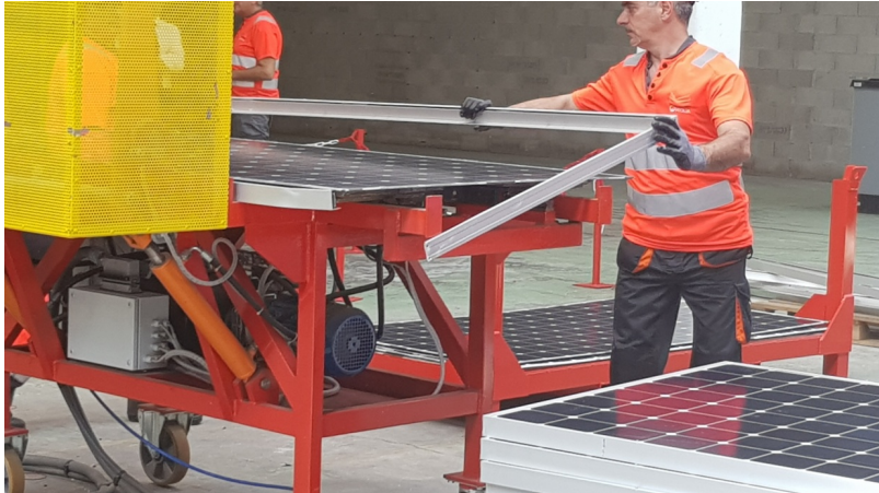
Figure 18 - Décadrage des modules (Source : REDEN)
