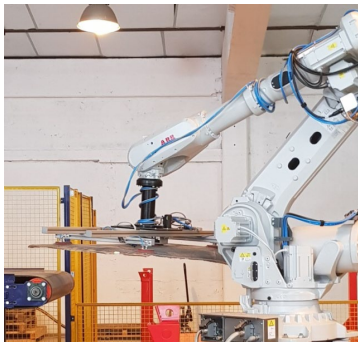
Figure 19 - Chargement du modules laminés avant découpage, broyage et séparation des éléments (Source : REDEN)
