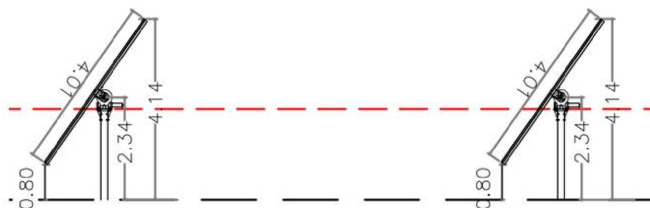
Exemple des tables trackers. Source: Reden Solar
