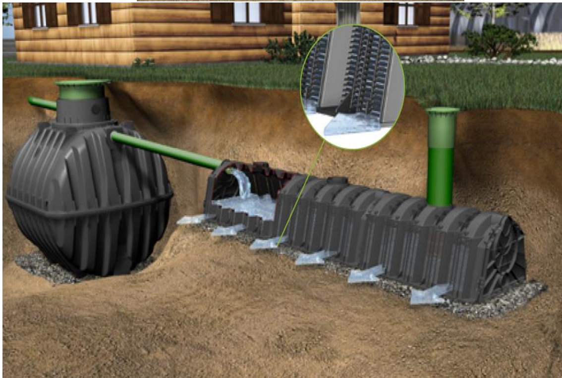
Figure VI.1 : illustration de tunnels d'infiltration (source : GRAF)
