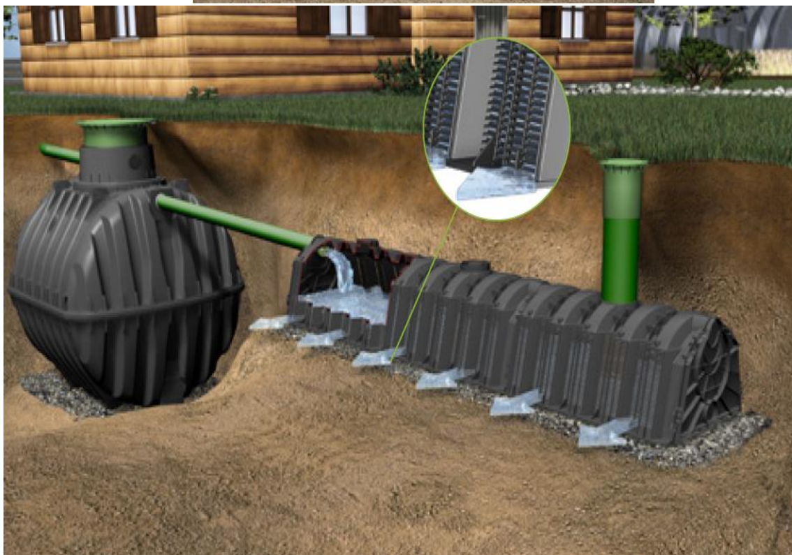
Figure VI.1 : illustration de tunnels d'infiltration (source : GRAF)
